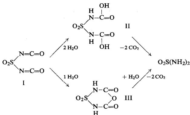
Bei langsamem Wasserzutritt, z. B. beim Stehenlassen der Substanz an feuchter Luft, läßt sich ein bei  $138-142^\circ$  schmelzendes Zwischenprodukt isolieren. Die Substanz ist sehr zersetzlich; die Analysenwerte schwanken daher. Es läßt sich nicht entscheiden, ob es sich bei dem Zwischenprodukt um Verbindung II oder das cyclische Anhydrid III handelt. Vermutlich liegt ein Gemisch beider Substanzen vor, hierfür spricht der unscharfe Schmelzpunkt.
